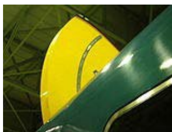
新幹線に付けられた 空気抵抗 増加装置 (空力ブレーキ)
