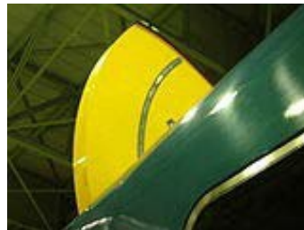
新幹線に付けられた 空気抵抗 増加装置 (空カブレーキ)
