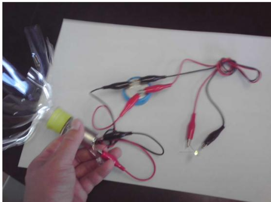
・プロペラを止めると LED 1 は消え、コンデンサの放電により LED 2 がしばらく灯る。
